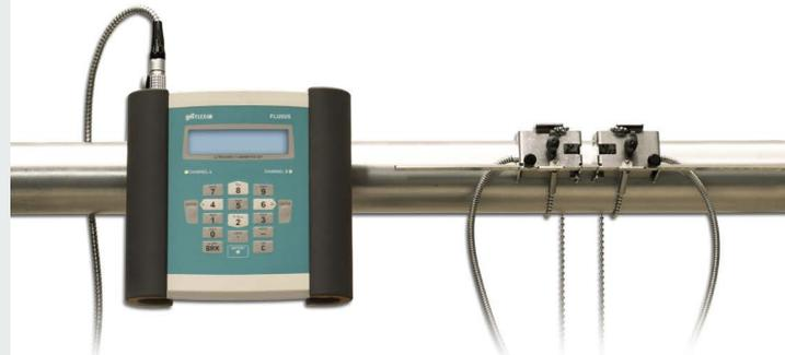
Mesure avec capteurs montés avec bloc-guides, et avec le transmetteur de débit fixé sur la conduite avec le kit de fixation QuickFix
