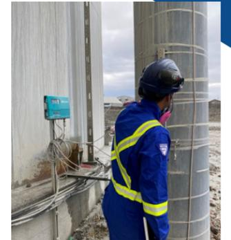
**Nous proposons également des mesures complètes de l'énergie thermique,** qui peuvent vous aider à évaluer les performances de vos échangeurs de chaleur ou le bon fonctionnement de vos tours de refroidissement. Nos capteurs de température à pince RTD, appariés et jumelés, offrent une précision remarquable de 0,06 °C.
